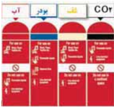
شکل ۱۰-۱- برچسب‌های استاندارد به صورت نوار رنگی روی کپسول
