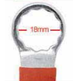
شکل ۴۷-۳- ابعاد آچار یک سر رینگی ۱۸ میلی متری
