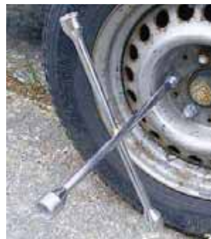
شکل ۶۴-۳- نحوه استفاده از آچار چرخ
