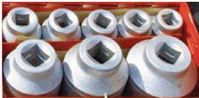
شکل ۵۳-۳- انواع شکاف مربعی آچار بکس
