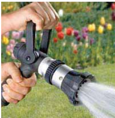
شکل ۱۸-۱ نحوه باز کردن شیر آتش نشانی
