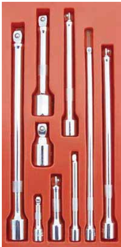
شکل ۶۱-۳- انواع رابط بکس
