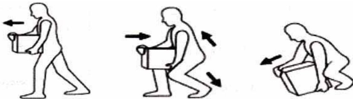
شکل ۲-۴- مراحل بلند کردن جسم سنگین
