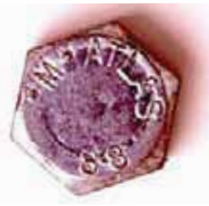
شکل ۱۷-۳- اعداد حک شده روی سر پیچ
