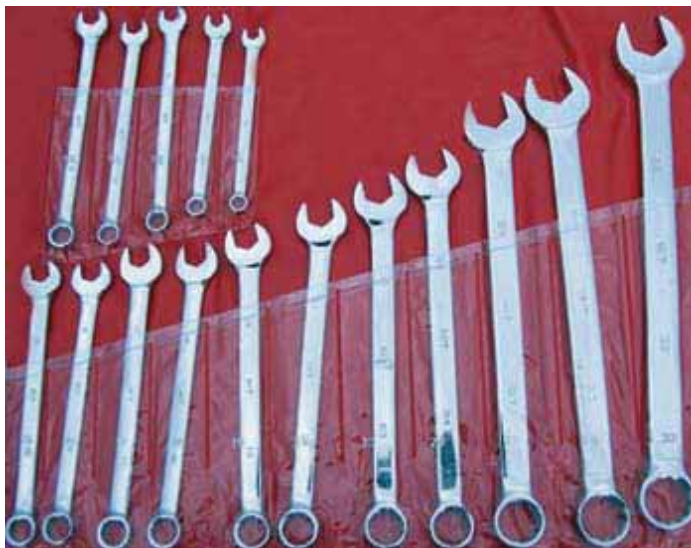
شکل ۴۸-۳- انواع آچار یک سر رینگی
