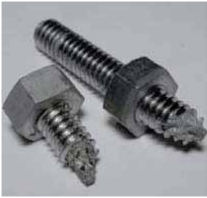
شکل ۳-۳۱- بریدن ساق پیچ
