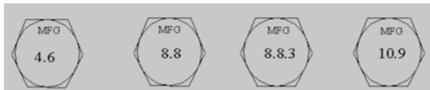
شکل ۱۸-۳- نمونه اعداد حک شده روی پیچ
