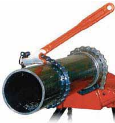
شکل ۸۱-۳- نحوه استفاده از آچار لوله گیر زنجیری
