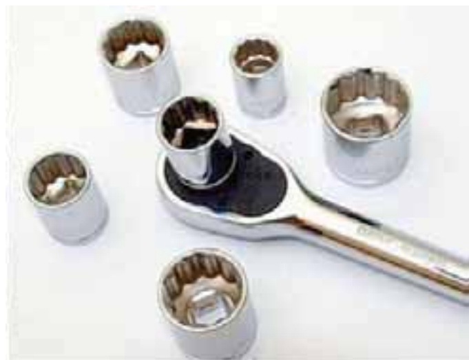
شکل ۵۶-۳- اتصال بکس به دسته بکس جنجغه ای
