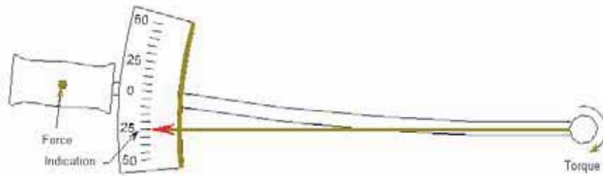
ب- وضعیت ترک متر درجه ای در حین کار
