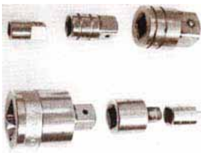
شکل ۵۲-۳- انواع تبدیل آچار بکس
