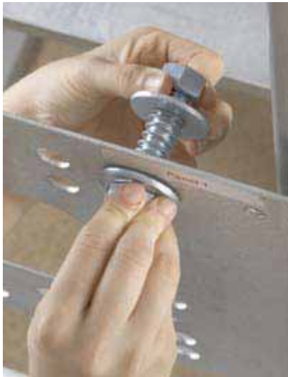
شکل ۱-۳- استفاده از پیچ و مهره برای اتصال
