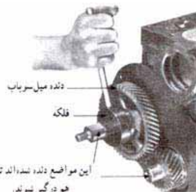
شکل ۲۹-۴- نحوه خارج کردن چرخ دنده از روی شافت با پولی کش مخصوص
