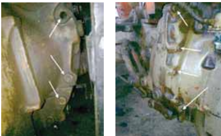
شکل ۱۳-۲- پیچ های اتصال موتور به جعبه دنده قسمت پایین
