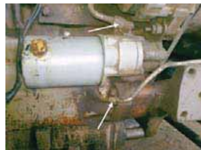
شکل ۱۵-۲- لوله های پمپ فرمان
