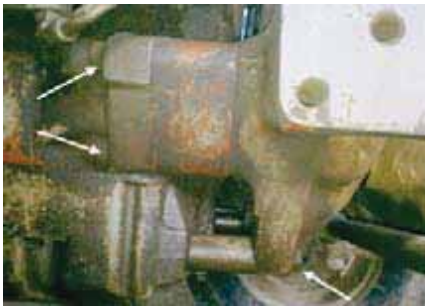
شکل ۱۸-۲- محل پیچ‌های اتصال موتور به جلو تراکتور
