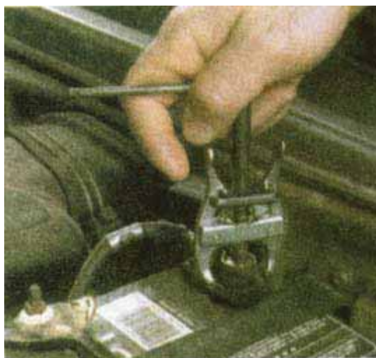
شکل ۲۸-۴- نحوه جدا کردن بست باتری با پولی کش
