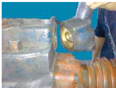
شکل ۲۱-۴- باز برداشتن درپوش ترموستات بعد از کردن پیچ‌های آن در تراکتور U650
