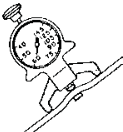
شکل ۲۷-۴- ابزار مخصوص اندازه‌گیری کشش تسمه
