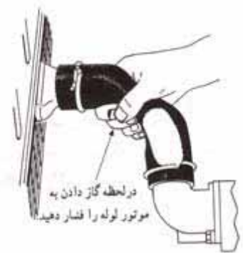
شکل ۲۰-۴- نحوه فشار دادن شیلنگ بالایی رادیاتور
