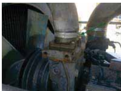
شکل ۱۱-۴- محل بست شیلنگ محفظه ترموستات و رادیاتور
