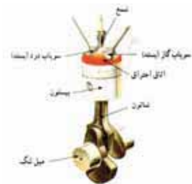
شکل ۳-۵- قطعاتی که در موتور حرکت رفت و برگشتی را به دورانی تبدیل می‌کنند
