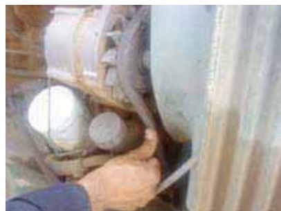
شکل ۲۸-۴- اندازه‌گیری کشش تسمه با فشار انگشت
