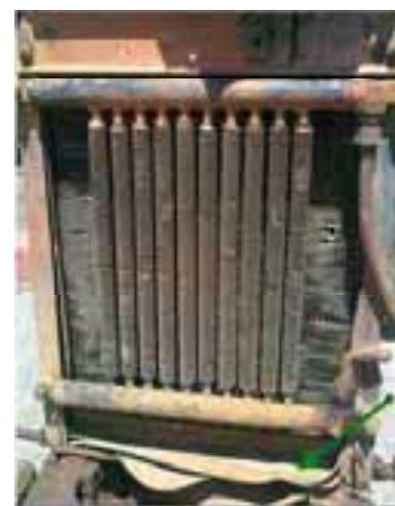
شکل ۱۳-۴- قرار دادن لاستیک زبین رادیاتور و پوسته فرمان در تراکتور U650
