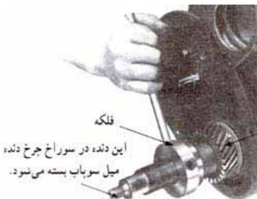
شکل ۲۹-۴- نحوه خارج کردن چرخ دنده از روی شافت با پولی کش مخصوص
