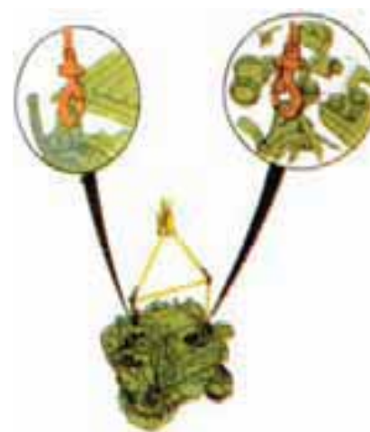
شکل ۱۰-۴- نحوه اتصال قلاب به محل اتصال وسایل به موتور
