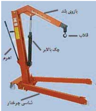
شکل ۱۱-۴- اجزای جرثقیل متحرک دستی
